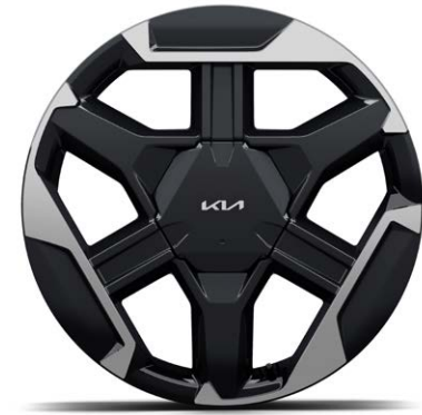
18" lichtmetalen velgen (235/55 R18 104V) Standaard voor GT-Line & GT-PlusLine uitvoeringen in combinatie met HEV aandrijflijn
