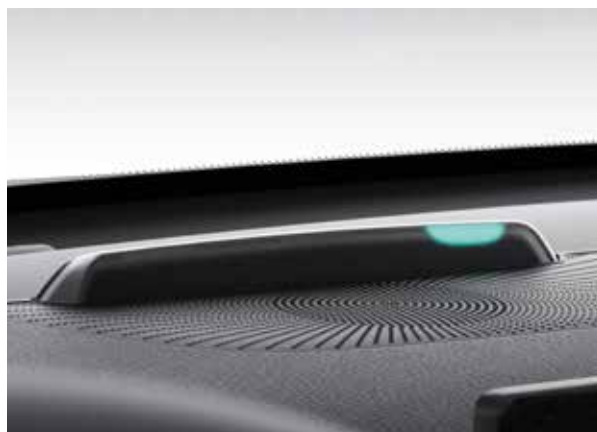
Laadindicator. Houd je laadstatus bij met de handige laadindicator. De drie LED-lampjes in de speaker-grille centraal in het dashboard zijn zelfs van buiten de auto goed te zien. Ze worden geactiveerd als je de laadstekker in het laadstation steekt en houden je op de hoogte van laadstatus en batterijniveau.
